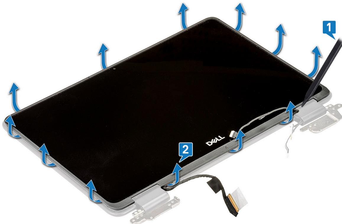
c Levante el panel de la pantalla del ensamblaje de la pantalla.
